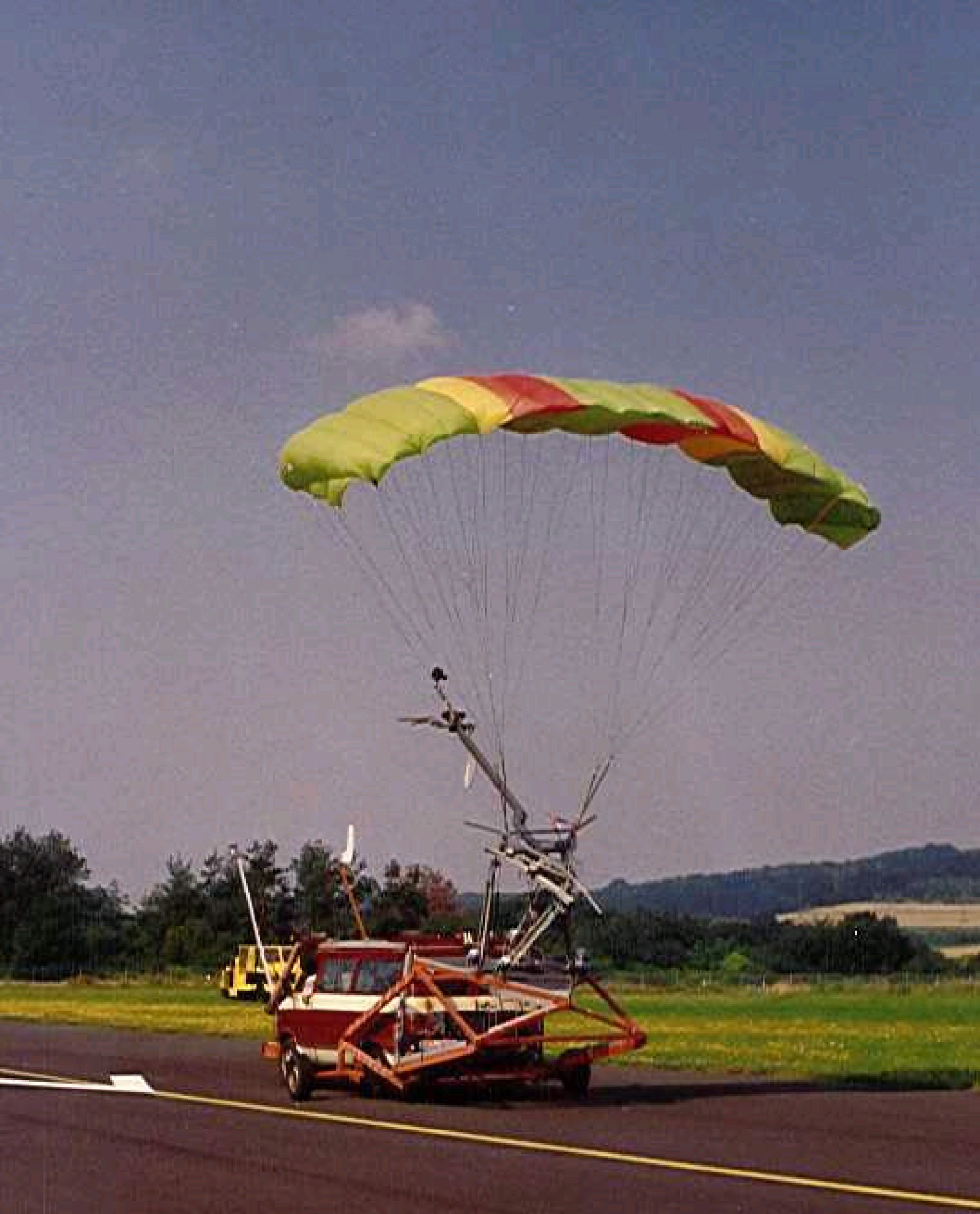
Erstmalige Gleitschirm-Flugmechanikmessung auf dem 6-Komponenten-Messwagen von Prof. Schönherr (1992)
